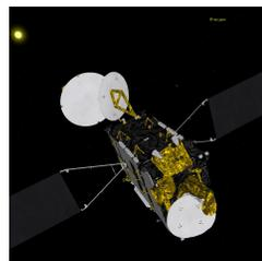
(d) Partially deployed second reflector
