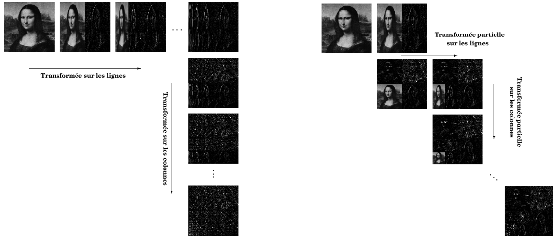
FIG. 2.11: Décomposition standard (à gauche) et non-standard (à droite) d'une image 2D
