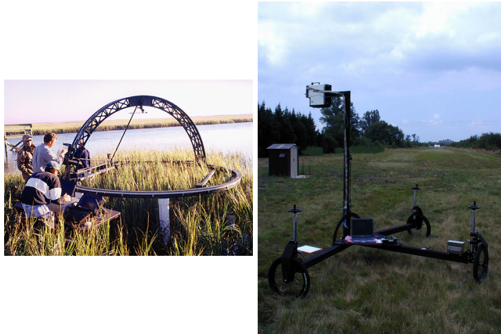
FIG. 1.8: Goniomètres extérieurs, banc FIGOS [SI99] à gauche, banc CHAMO de l'ONERA à droite
