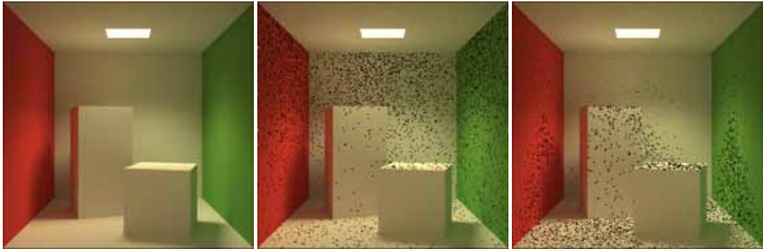
FIG. 4.31: Éclairage à partir de la description d'un luminaire réel, à gauche : solution de référence (tracer de chemin), au centre : points d'impact initiaux des photons pour un échantillonnage uniforme de la source, à droite : points d'impact initiaux des photons pour un échantillonnage par ondelettes
