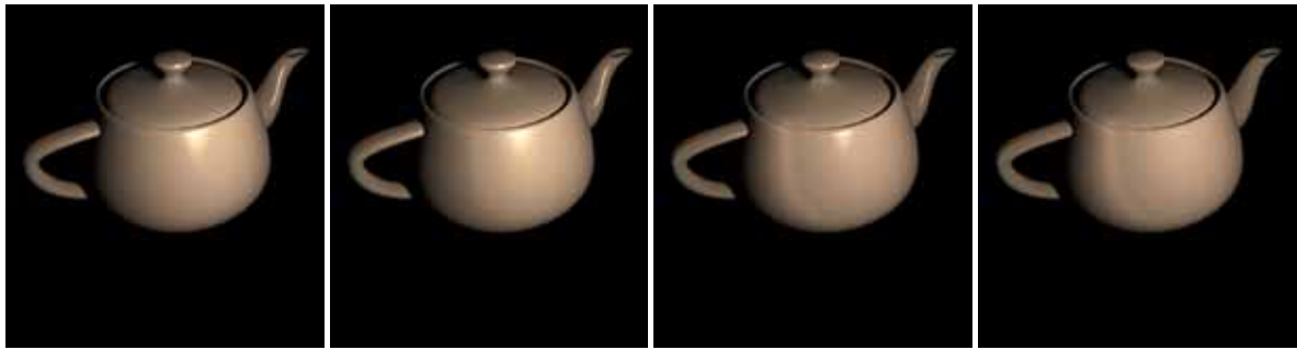
FIG. 4.14: FDRB du plastique appliquées sur une théière visualisée en lancer de rayons, de gauche à droite : FDRB non compressée, à 10 :1, compressée à 20 :1, à 50 :1
