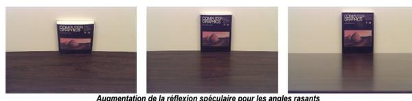
FIG. 1.5: Augmentation de la réflectivité d'un matériau pour les angles rasants
